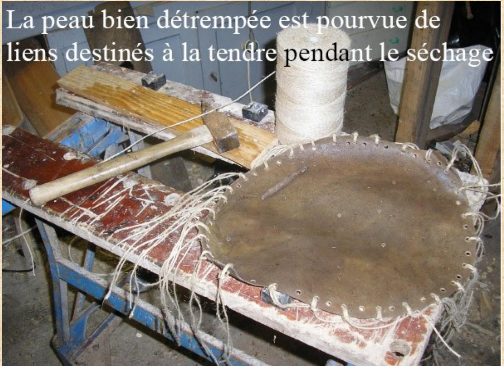
La peau encollée à la colle de peau pour plus de sécurité est maintenue avec les cordelettes et une corde horizontale pour lui faire prendre la forme de la dépression du bord
