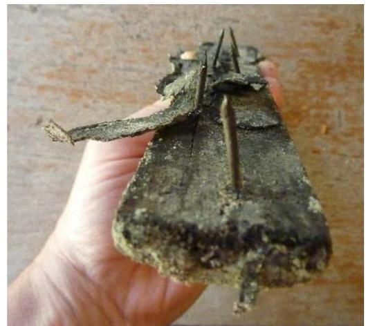
Détail de l'étanchéité par palâtre cloué
